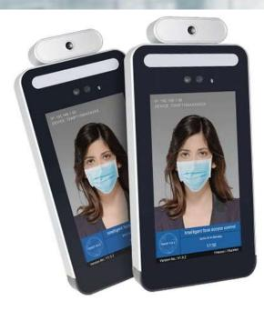
función de medición de temperatura facial. Puede tomar de forma rápida y precisa la temperatura del cuerpo humano, posee alarma para cuando la temperatura es demasiado alta. Se utiliza principalmente en edificios de oficinas, salas de examen, ferrocarriles, bancos, industrias de la construcción, hoteles y otros lugares donde se necesita identificación y temperatura.
